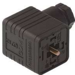
Gerätesteckdose Typ A 3+PE DIN EN 175301-803, ISO 440/6952, (ex DIN 43650 A)
